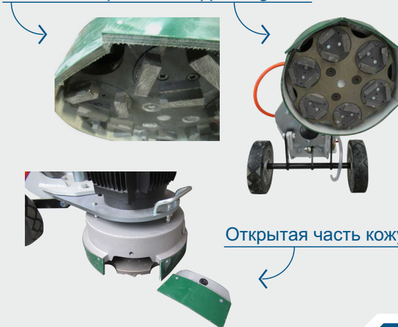
Надёжное крепление фрез Mg80S
