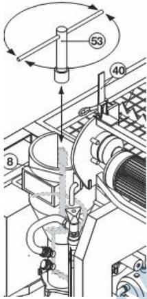
**Запуск агрегата:** перед началом работы, обязательно открыть смесительную камеру, вынуть миксер и при помощи специального ключа повернуть шнек насоса и убедиться, что у него свободный ход.
